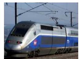
TGV duplex 9,1 MW (mécanique)
